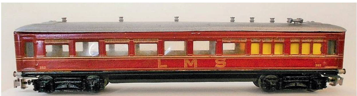
vierachsiger Personenwagen (Typ 352) LMS Stempelung groß, mittig des Wagenkastens, große einteilige Guß Drehgestelle, Bj. 1938, KK 3
